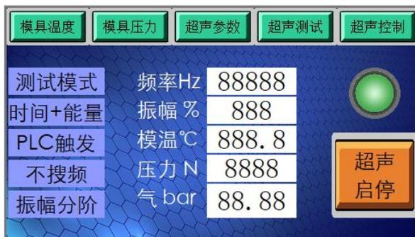
此画面中所有参数只可查看，不可修改，在按键触发工作模式下可通过右下角按钮控制超声启动或停止，当超声工作时右上指示灯亮绿灯。
