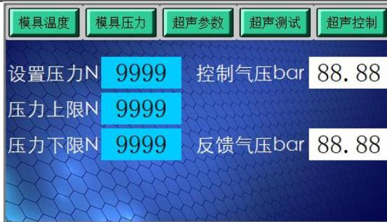
压力单位为N,是压缩空气通过气缸作用在工件上的力,工件作用面积不同时,在工件上会产生不同的压强。
