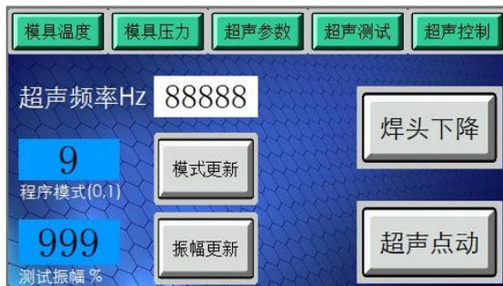
蓝色区域右调整参数，调整后点右侧更新按钮，下载参数到发生器，此参数只对发生器本次开机有效。
