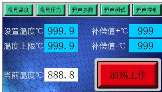
右下角的按钮是启动或停止加热功能，红色表示加热工作。当前温度显示实际温度，如未接线或断线则会显示>500℃。
